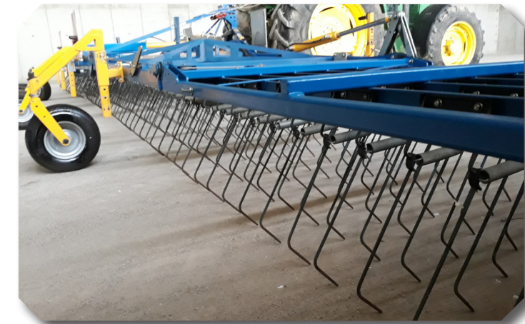
Ci-dessus, la herse étrille et ci-dessous, la bineuse présentes sur l'exploitation - EARL BIORAE Crédits SMAV
